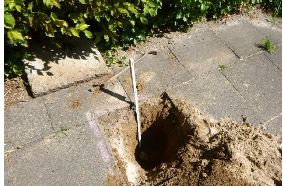
Abb. 63: Nahaufnahme Schurf 4 (Tiefe ~ 55 cm)
