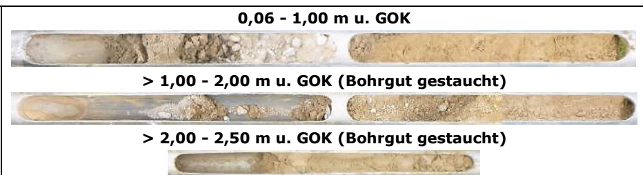
Abb. 38: Bohrgut aus KRB 14b
