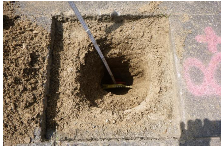
Abb. 61: Nahaufnahme Schurf 3 (Tiefe ~ 60 cm)
