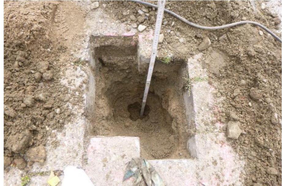
Abb. 59: Nahaufnahme Schurf 2 (Tiefe ~ 60 cm)
